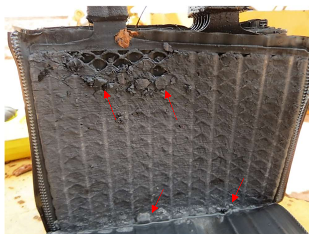
Figuras 64 e 65 - Fragmentação da placa negativa de chumbo, o que promove o curto-circuito interno. Fonte: Acervo pessoal.
