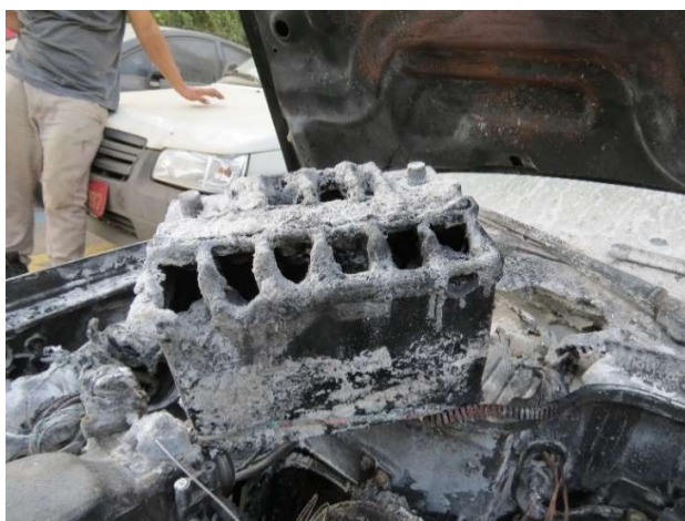
Figuras 46 e 47 – Setas vermelhas mostram polos positivo e negativo da bateria, sem anormalidades técnicas por derretimento. Fonte: Acervo pessoal.
