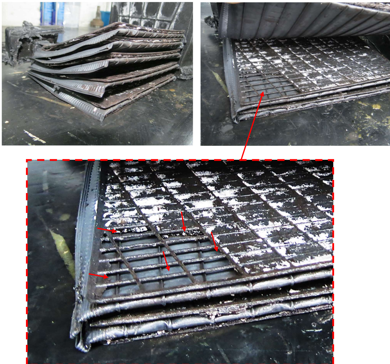
Figura 57 e 58 – Setas vermelhas mostram anormalidades técnicas por descolamento das placas de chumbo do vaso positivo, evidenciando a degradação e ruptura parcial da estrutura. Fonte: Acervo pessoal.
