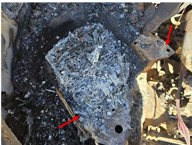
Figuras de 26 a 29 – Mostram compartimento veículo Frontier danificado por incêndio e compartimento do motor em que ocorreu a movimentação da bateria por 5 cm (cinco centímetros) devido à ausência da trava ou suporte. Fonte: Acervo pessoal.
