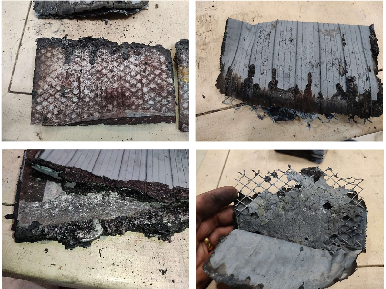
Figuras de 16 a 19 - Formação de cristais de sulfato de chumbo nas placas internas, deterioração da grade, indicando sulfatação avançada e curto-circuito. Fonte: acervo pessoal.
