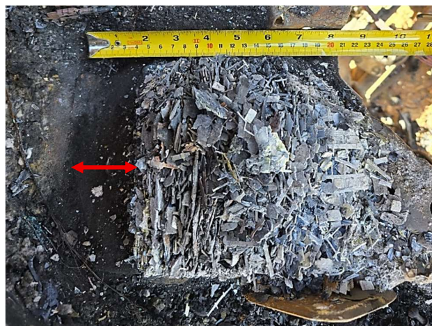
Figuras de 26 a 29 – Mostram compartimento veículo Frontier danificado por incêndio e compartimento do motor em que ocorreu a movimentação da bateria por 5 cm (cinco centímetros) devido à ausência da trava ou suporte. Fonte: Acervo pessoal.
