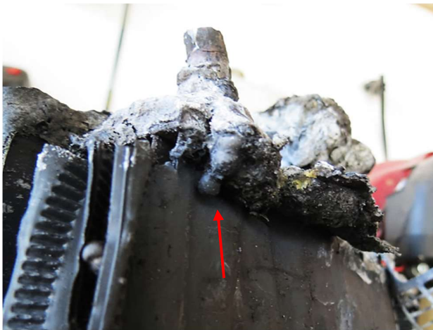
Figuras 68 e 69 - Formação de cristais de sulfato de chumbo em placas internas, indicando sulfatação avançada e curto-circuito. Fonte: Acervo pessoal.
