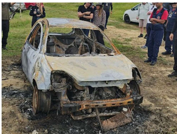
Figuras 76 e 77 - Veículo Ford Ka com danos por queima. Fonte: Acervo pessoal.
