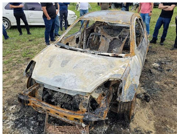
Figuras 76 e 77 - Veículo Ford Ka com danos por queima. Fonte: Acervo pessoal.
