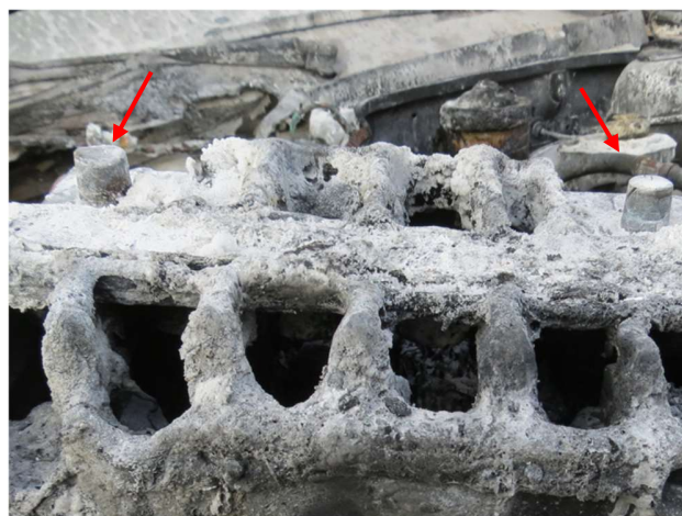
Figuras 46 e 47 – Setas vermelhas mostram polos positivo e negativo da bateria, sem anormalidades técnicas por derretimento. Fonte: Acervo pessoal.
