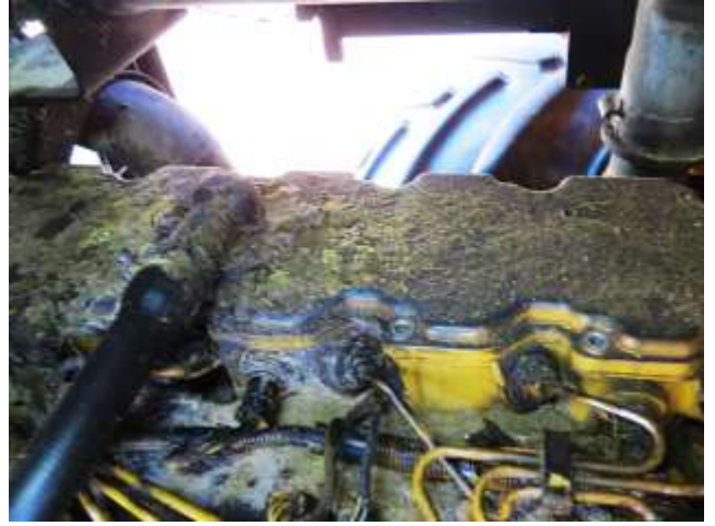
Figuras 13 e 14 (autor, 2025) – mostram panorâmica da parte superior do motor, com uma camada de pó branco de cana-de-açúcar impregnadas na superfície.
