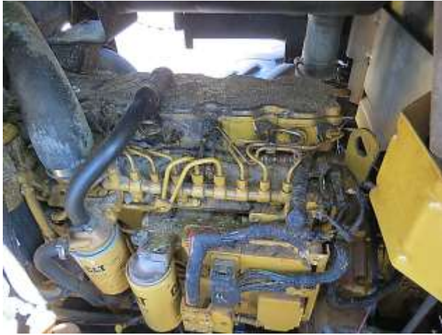
Figuras 13 e 14 (autor, 2025) – mostram panorâmica da parte superior do motor, com uma camada de pó branco de cana-de-açúcar impregnadas na superfície.
