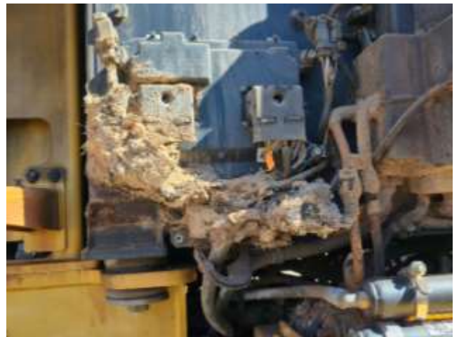
Figuras 13 e 14 (autor, 2025) – mostram panorâmica da parte superior do motor, com uma camada de pó branco de cana-de-açúcar impregnadas na superfície.
