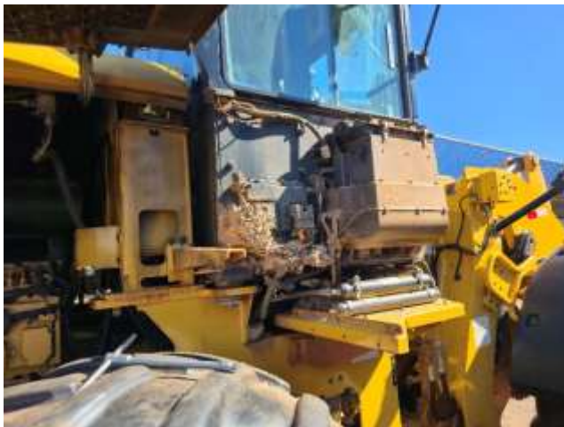
Figuras 13 e 14 (autor, 2025) – mostram panorâmica da parte superior do motor, com uma camada de pó branco de cana-de-açúcar impregnadas na superfície.
