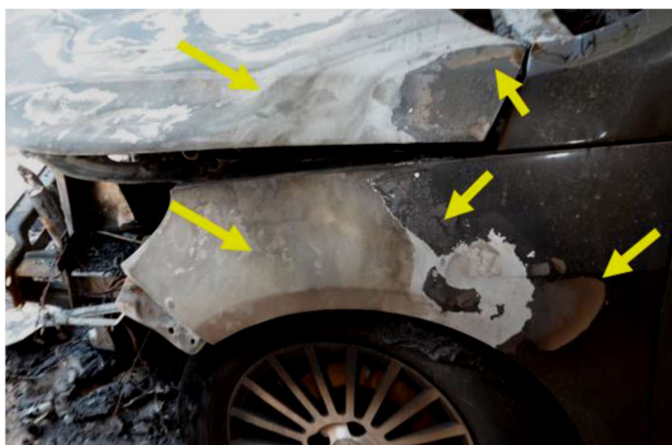
Figura 2 - Verificam-se também marcas compatíveis com o derramamento de substância acelerante que provocaram também a queima e a descoloração da pintura. Fotografia: Heraldo Cordeiro.
