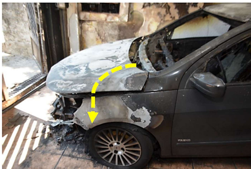
Figura 2. Quando uma substância acelerante é derramada sobre um veículo, padrões de escoamento, como os verificados no capô em solução de continuidade com o para-lama, ficam visíveis nas superfícies externas. Fonte: Acervo pessoal. Fotografia: Heraldo Cordeiro.
