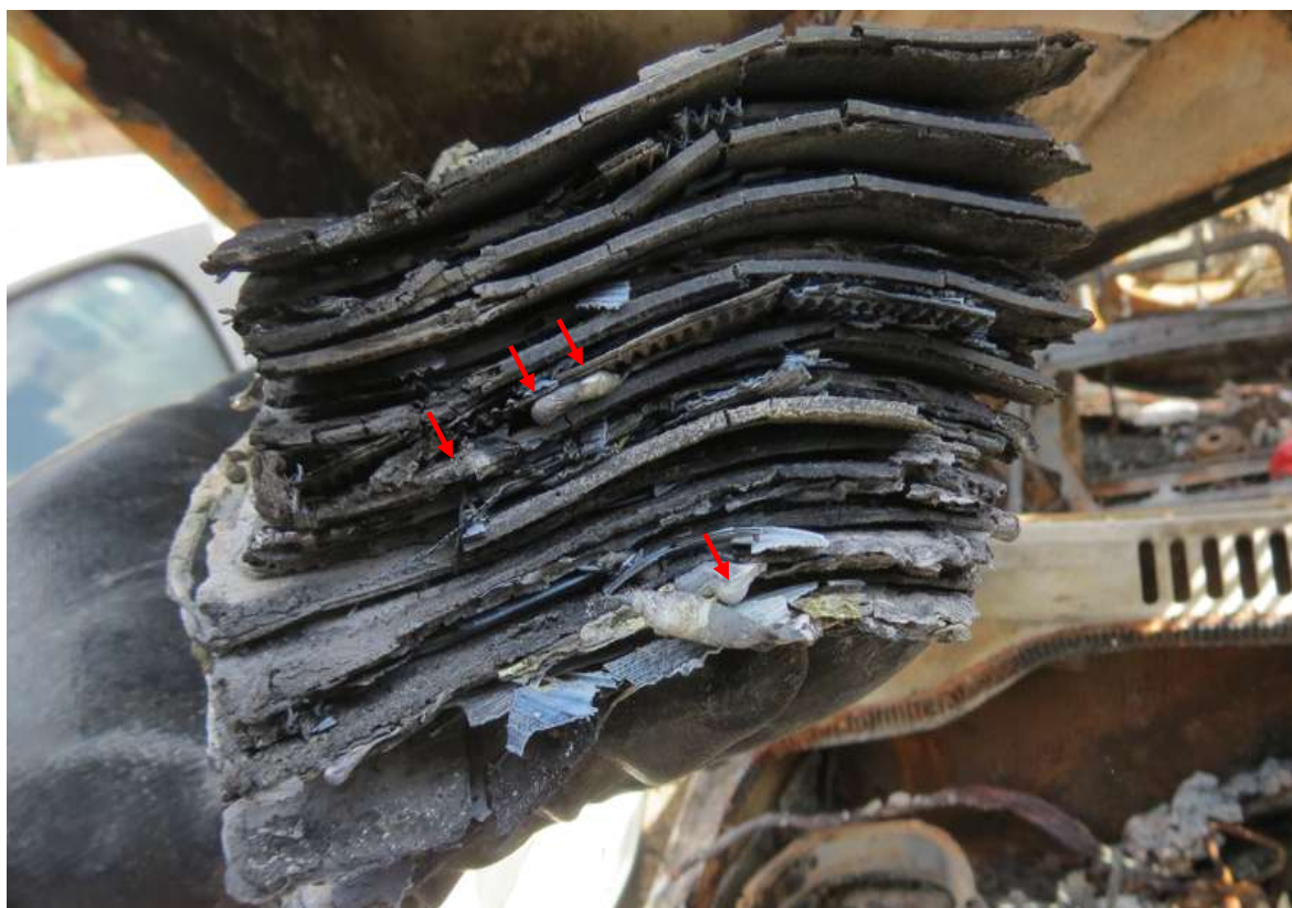
Imagens 26 a 28 – Setas vermelhas mostram placas positivas, apresentando danos por queima, contaminação e formação de pérolas de fusão.
