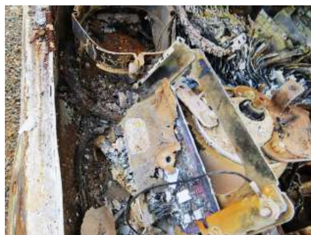
Figuras 10 a 13 – Setas vermelhas mostram fiações adversas do habitáculo do motor com danos por queima, sem anormalidades técnicas por curto-circuito ou fusão.
