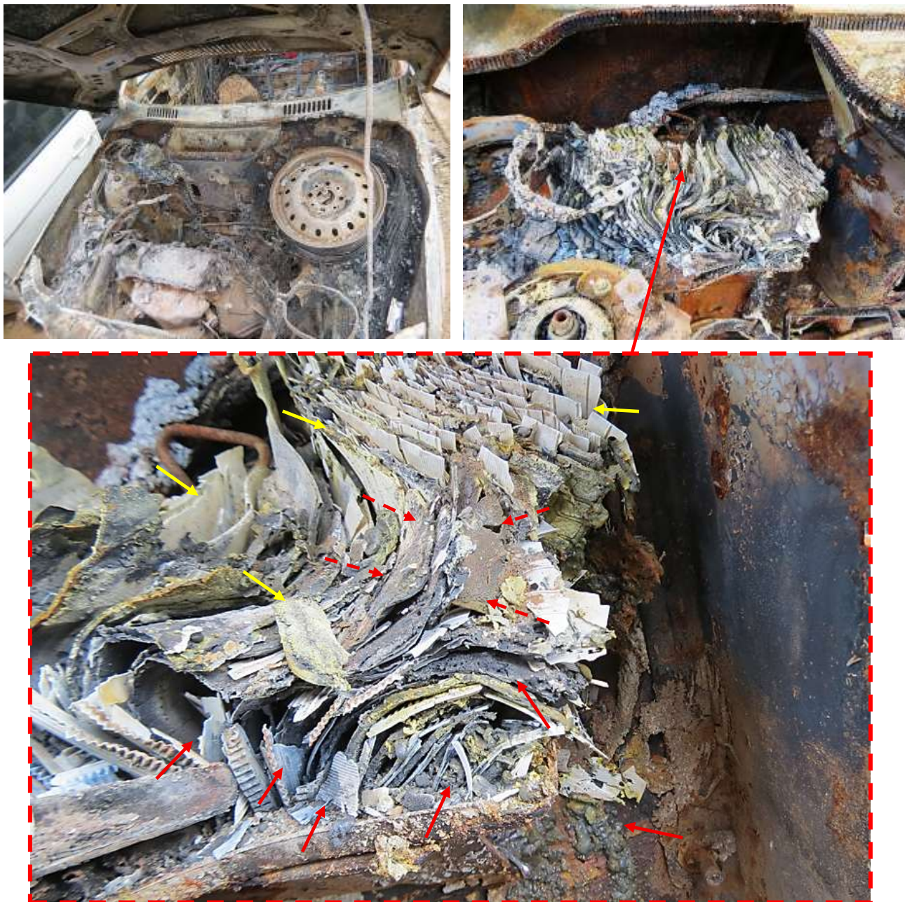
Figuras 22 e 23 – Setas amarelas mostram vestígios de danos nas placas positivas, evidenciando fusão completa e fragmentação dos materiais, além de contaminação por óxido de chumbo (PbO), caracterizado pela tonalidade amarelada.
