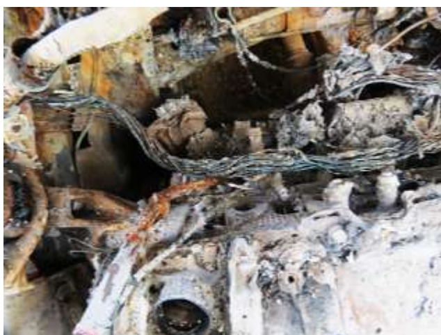
Figuras 10 a 13 – Setas vermelhas mostram fiações adversas do habitáculo do motor com danos por queima, sem anormalidades técnicas por curto-circuito ou fusão.
